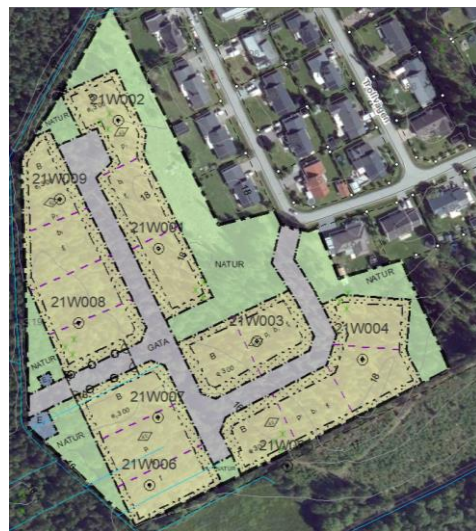
Figur 5. Borrpunkter för geoteknik.
