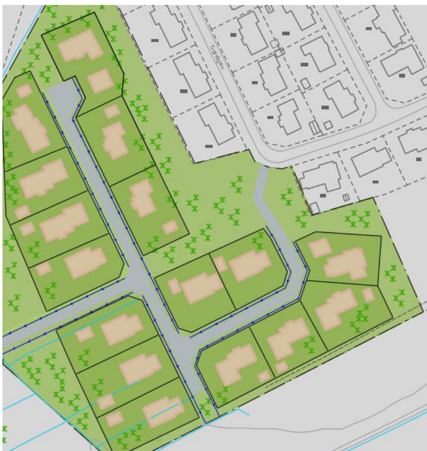
Figur 8. Flödespilar som visar hur dagvattnet kan hanteras genom ytavrinning.
